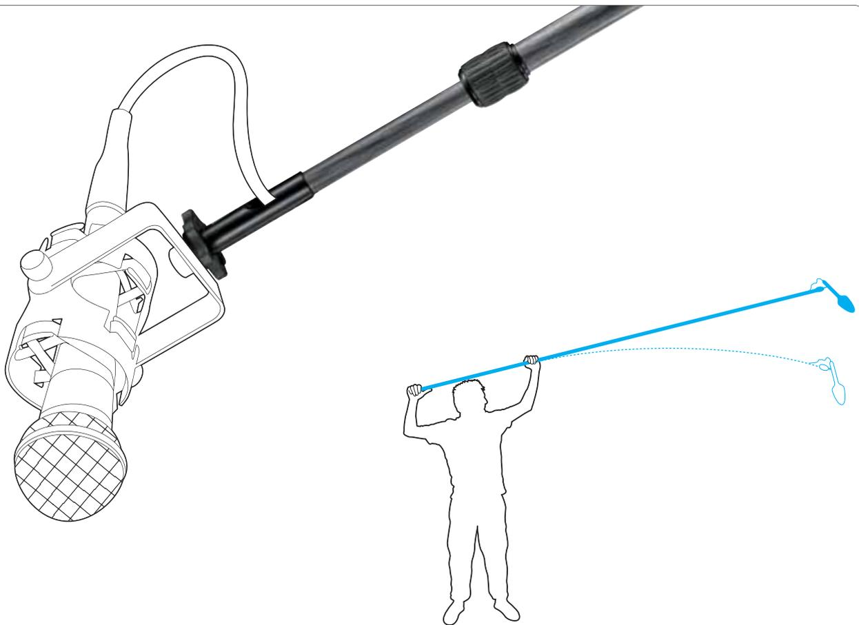
Gitzo Gelenkarme haben eine umkehrbare Anzugsschraube  $\frac{1}{4}$ " –  $\frac{3}{8}$ " mit einem hochwertig gearbeiteten Alu-Oberteil. Das Mikrofonkabel kann entweder außerhalb oder innerhalb des Rohres geführt werden. Das Alu-Oberteil ist mit einem Loch für Innenkabel versehen.
