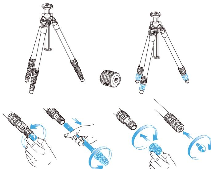
Spezielle Reduzierstücke gestatten die Verkürzung eines beliebigen Gitzo Dreibein- oder Einbeinstativs in vier einfachen Schritten: Gewünschtes G-Lock lösen, das gesamte Bein abnehmen, Reduzierstück einschrauben und gewünschten Fuß an das Reduzierstück ansetzen. Die abgenommenen Beinteile können in der mitgelieferten Staubschutztasche aufbewahrt werden.
