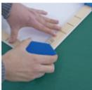
Entfernen Sie die Eckverbindungsstücke, indem Sie sie nach oben wegziehen. Dabei müssen die Leisten festgehalten werden.
