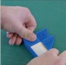
Entfernen Sie den gelben Klebestreifen von den Leisten. Schieben Sie die Leisten mit der Klebefläche nach oben in die Positionierungsecken. Die Leisten müssen bündig und fest hineingesteckt sein. Die Positionierungsecken haben Nasen, so dass die Leisten nur seitlich hineingeschoben werden können.
