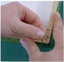
Klappen Sie die Leisten nach oben, um den Rahmen zu schließen. Stecken Sie die Klammern in die Einschubslitze und drücken oder hämmern Sie sie vorsichtig bündig in den Rahmen. Wiederholen Sie dies bei allen Ecken.
