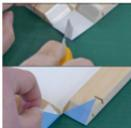
Schneiden Sie die Ecken von dem Punkt aus, an dem sich die Leisten in einem 45°-Winkel treffen, nach außen hin ein. Schlagen Sie die Ecken dann über die Klebefläche.
