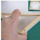
Schieben Sie die vier Stützkeile in die V-Schlitz der Rahmenecken. Die Stützkeile dürfen dabei nicht auf dem Bild aufliegen.
