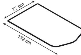
Der aus einer einzigen MDF-Platte vorkonfektionierte Aufnahmetisch wird von Anwender selbst zusammengesetzt und verschraubt. Die mitgelieferte Hintergrundplatte aus flexiblem Kunststoffschaum wird in den Tisch eingesetzt und durch Klebbänder fixiert. Der gleichmäßig gekrümmte Hintergrund („open tube“-Kontur) unterstützt die Lichtverteilung auf dem Objekt.
