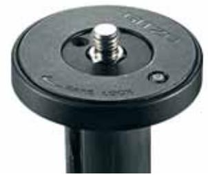
Der obere Auflageteller wurde durch die Version "Power Disc" verbessert. Diese wird aus maschinell bearbeitetem Aluminium hergestellt und besitzt außer dem Material für einen sicheren Verschluss auch eine Verschlusschraube für die Säule und eine zusätzliche Verschlusschraube für den Stativkopf, mit der eine felsenfeste Verbindung gewährleistet wird. Die umkehrbare Schraube 1/4"-3/8" wurde neu gestaltet und funktioniert jetzt zuverlässiger.
