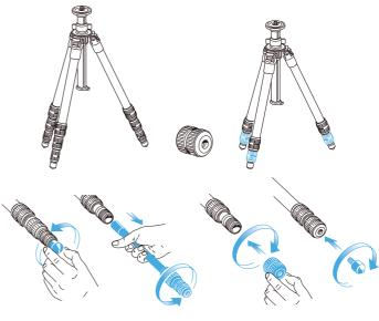
Spezielle Reduzierstücke gestatten die Verkürzung eines beliebigen Gitzo Dreibein- oder Einbeinstativs in vier einfachen Schritten: Gewünschtes G-Lock lösen, das gesamte Bein abnehmen, Reduzierstück einschrauben und gewünschten Fuß an das Reduzierstück ansetzen. Die abgenommenen Beinteile können in der mitgelieferten Staubschutztasche aufbewahrt werden.
