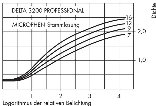
Schwärzungskurve des DELTA 3200 PROFESSIONAL, entwickelt in ILFORD MICROPHEN (Stammlösung) in 7, 9, 12 und 16 Minuten bei 20°C mit intermittierender Bewegung.
