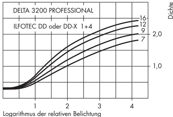
Schwärzungskurve des DELTA 3200 PROFESSIONAL, entwickelt in ILFOTEC DD-X (1+4) in 7, 9, 12 und 16 Minuten bei 20°C mit intermittierender Bewegung.
