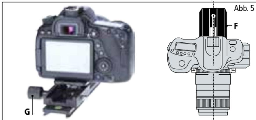
Bevor die Grundplatte wieder auf den Panoramakopf aufgesetzt wird, prüfen Sie die Ausrichtung der Kamera zur Grundplatte. Die Achse der Linse und die Mittelachse der Grundplatte müssen wie in Abb. 5 gezeigt perfekt übereinstimmen.
